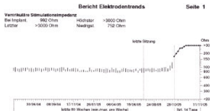
Abb.10 Der elektrische Widerstand einer Elektrode zeigt im Speicher nach –über Monaten- stabilen Werten einen plötzlichen Anstieg des elektrischen Widerstandes –typisch für einen Elektrodenbruch
